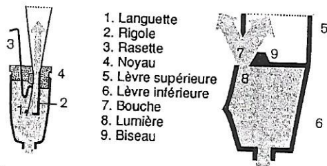
D. Tuyaux à anche et tuyaux à bouche
